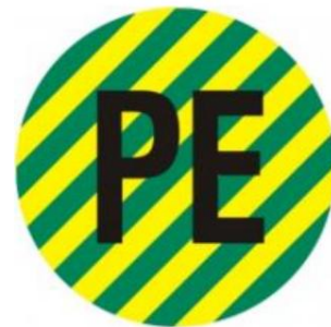
Figura 4: Conductor de protección de tierra
