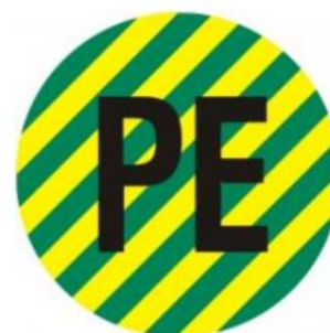
Ilustracja 4: Przewód ochronny uziemienia
